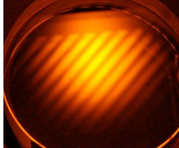
Figura 3.13 Interferencia entre dos planos ópticos.
